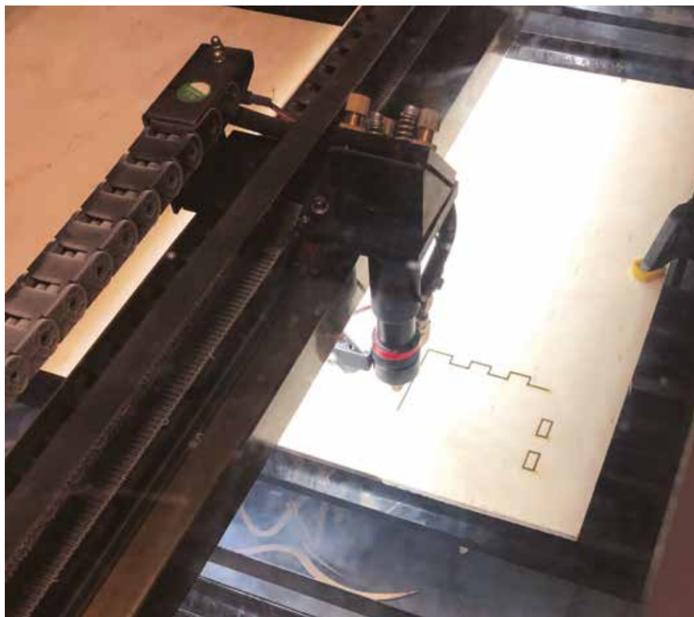
Herover: viser Martin hvordan man sætter materialet i laserskæreren. Herunder: De første snit i en ny krydsfinerplade.
