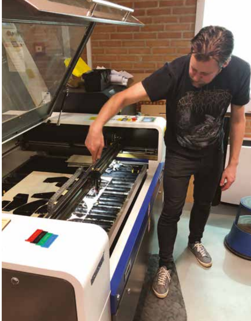
Herover: viser Martin hvordan man sætter materialet i laserskæreren. Herunder: De første snit i en ny krydsfinerplade.
