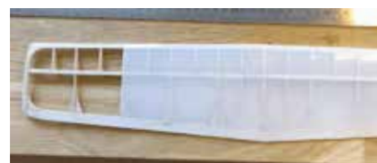
Oversidens hvide folie er skåret til og strøget fast med foliejernet.
