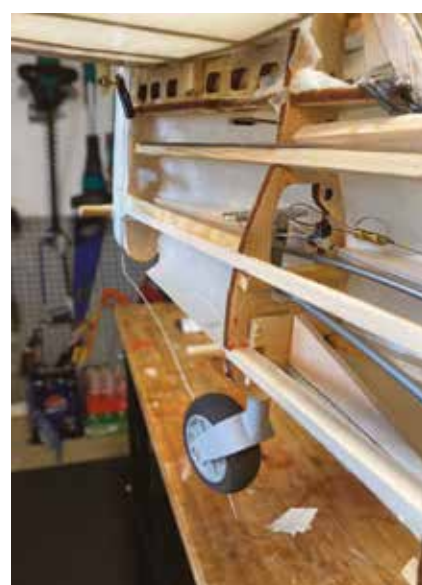
Halehjul med wires inden glasfiber "hud" limes på
