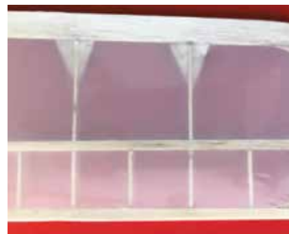
Vupti – så har foliejernet gjort arbejdet færdigt. En glat og fin tip!
