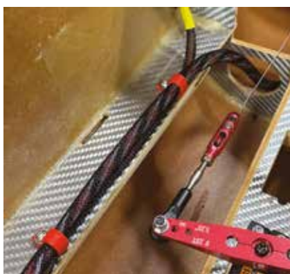
Orden skal der være ... hele vejen. Det sørger de små selvprintede clips for.
