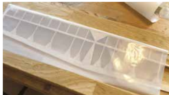
Det første stykke OraLight er skåret ud, og beskyttelsesfolien er fjernet. Folien ligger løst på haleplanets underside med limsiden ned mod haleplanet. Man kan se, at folien ikke ligger helt rigtigt – afskæringen i højre side skal passe præcis med ribben.
