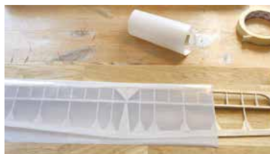
Her er folien placeret korrekt, og den er "duppet" fast med foliejernet, som står på ca. 90 grader.
