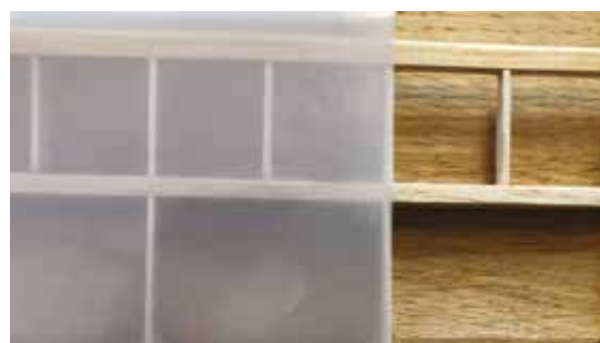
Folien er strøget fast på undersiden af haleplanet. Bemærk hvordan folien lige præcis dækker ribben, hvor beklædningen med rød folie skal starte.
