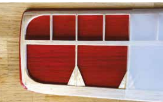
Her er undersidens folie sat fast, udhænget er bukket rundt og limet fast.
