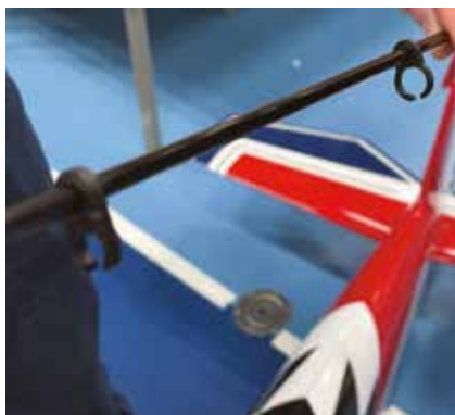
Her ses ledningsklipsene midt på stangen.
