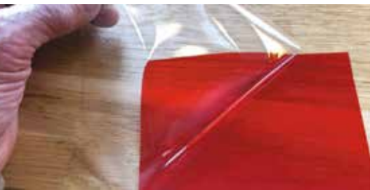
Her kan man se, hvordan beskyttelsesfolien trækkes af. Den er svær at se, før man får skilt den fra beklædningsfolien.
