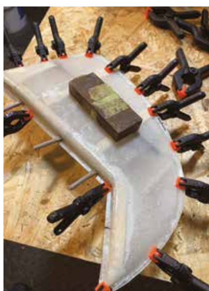
Limning af sideror med Polyurethanlim
