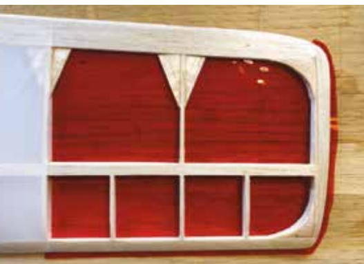
Der er lagt rød folie på undersiden, og man kan se udhænget i tippen og ved forkantslisten.
