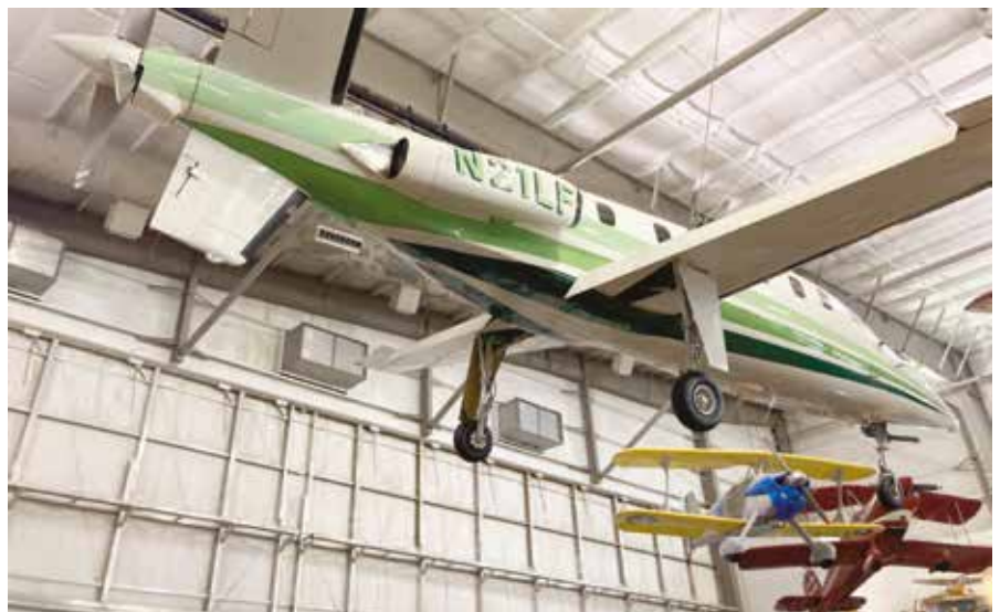
Den meget futuristiske Lear Fan 2100 var et godt bud på et tomotoret fly med kun én propel. Man var nødt til at lave en halefinne på undersiden for at undgå at propellen kunne ramme jorden hvis næsen kom for højt op.
