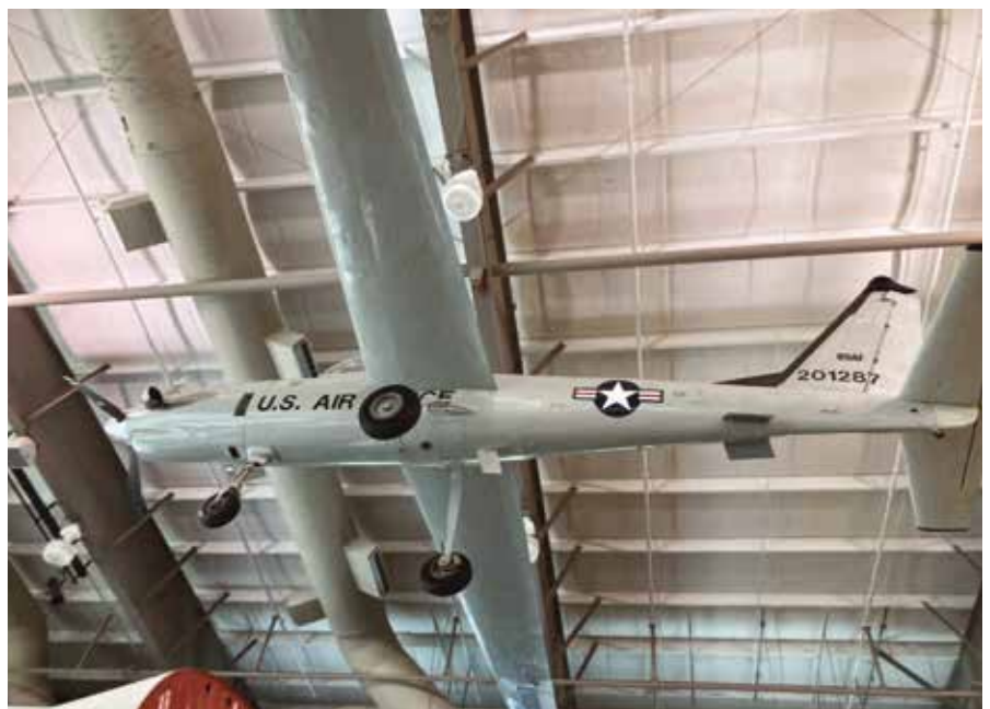
De smalle vinger på L-450 afslører et slægtskab med et svævefly. Med tiden blev der både monteret turboprop motor og fungerede som Drone under betegnelsen XQM-93A. Den kunne være i luften i over 21 timer. Motoren var en PT6A-34 .
